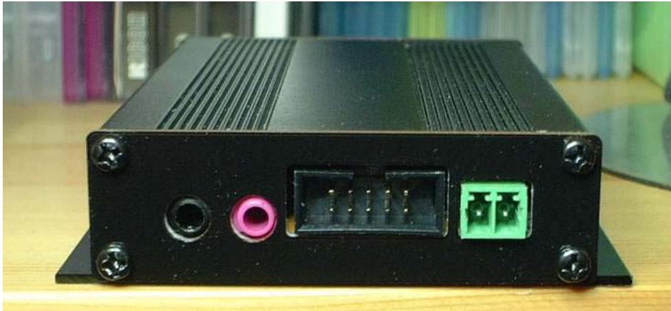
ME86 背面：供电端口，串口，麦克风，耳机
