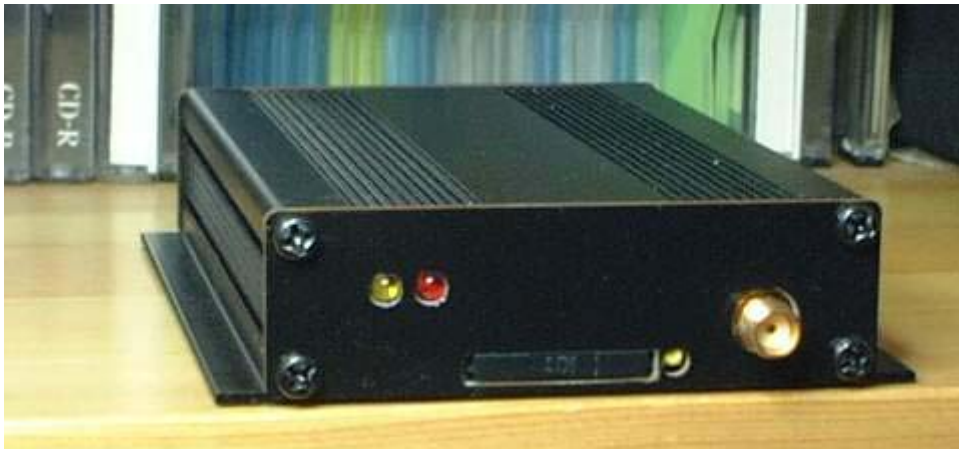
ME86 正面：天线接口 SMA，SIM 卡，指示灯
